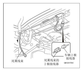
72. 如图所示放置尾翼线束,用 2 条线束胶带把 尾翼线束固定在车辆线束上。
