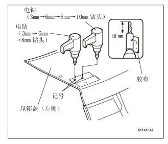
46. 用电钻把打孔机做的1处记号钻开图示的孔。
