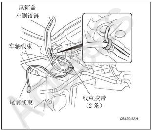
73. 如图所示放置尾翼线束,用4条窄的线束胶带 把尾翼线束固定在车辆线束上。
