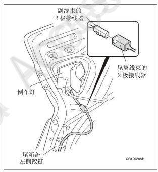
75. 用3条线束胶带把尾翼线束固定在车辆线束上。
