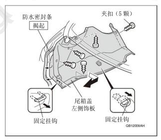
27. 拆出 3 颗夹扣和 4 处爪扣,拆出尾箱盖左侧 铰链盖板。
