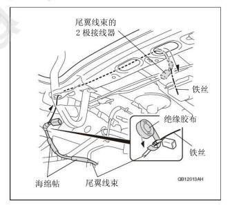
65. 拆开高位刹车灯的 2 极接线器和车辆 2 极接线器的接线。
