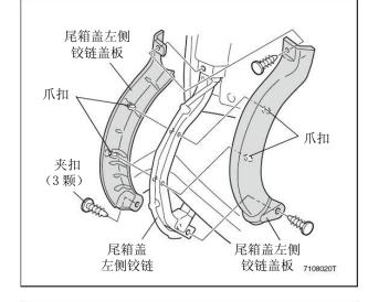
29. 拆出8颗夹扣,拆卸下尾箱盖饰板。
