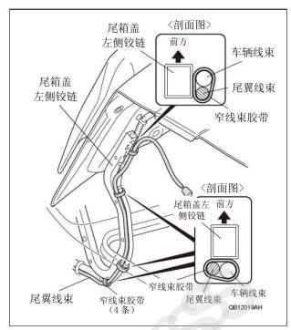
74. 把副线束的 2 极接线器与尾翼线束的 2 极接线器接通。
