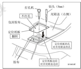
45. 用电钻把打孔机做的 2 处记号钻开图示的孔。
