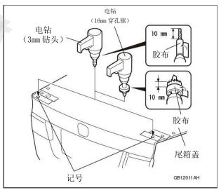
51. 把 2 个环扣安装在孔径 16mm 的孔中。
