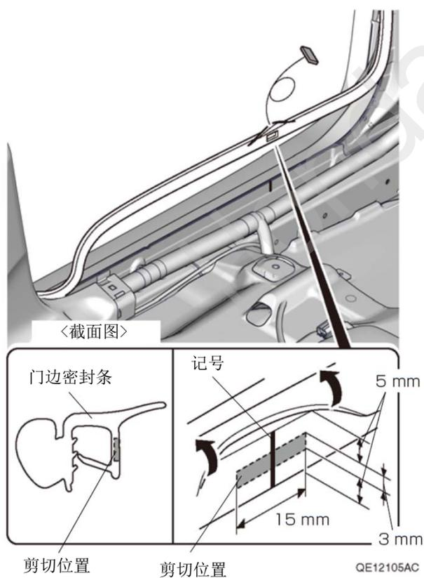
31. 拔出门边密封条的芯铁。
