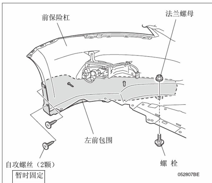
22. 用2个夹扣把左前包围固定在前保险杠上，用力压紧夹扣直到顶住前保险杠为止，把多余部分剪断。
