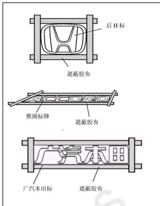
8. 用风筝线（丝线）分别在“后H标”，“ACCORD”，“广汽本田”粘贴面活动，如图所示方向拉动丝线，使粘贴面的双面胶脱落，然后取下“后H标”，“ACCORD”，“广汽本田”三块标牌。
