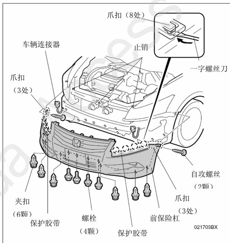
4. 将拆下的大包围放在防刮花的软板上，然后用剪钳剪断前格栅H标的两根柱子，取下锁住H标的两个防松螺母，最后拆下车上原装的前H标。
