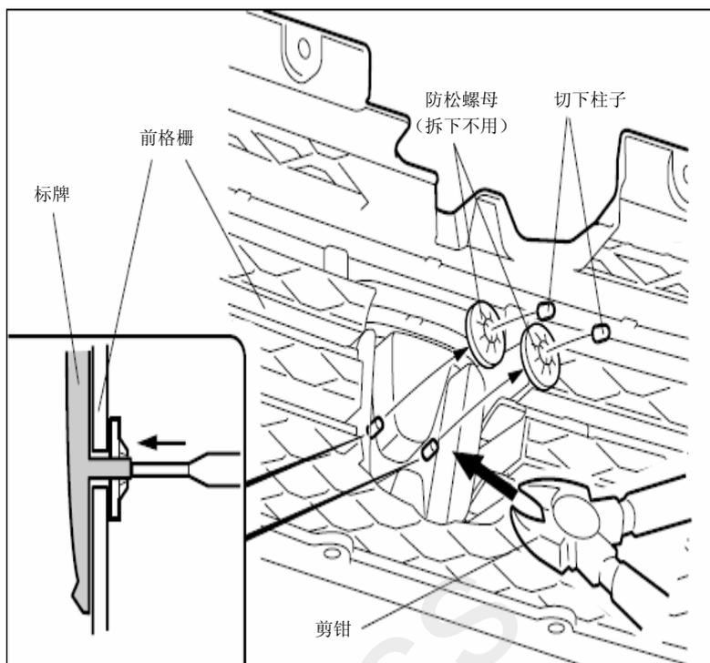
5. 将装配前H标的地方（前格栅）用清洁剂清洗，擦干后将镀金的前H标装在前格栅上，将防松螺母套在H标的柱子上并锁住H标（注意装好后检查H标是否有松动）。
