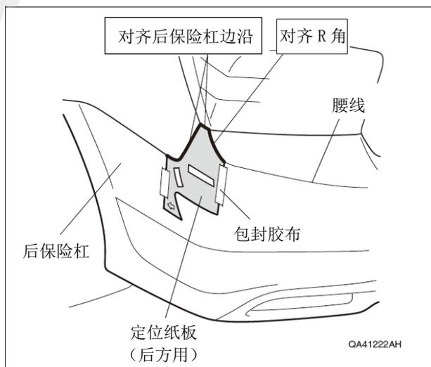
配备倒车雷达的车辆转顺序 15
