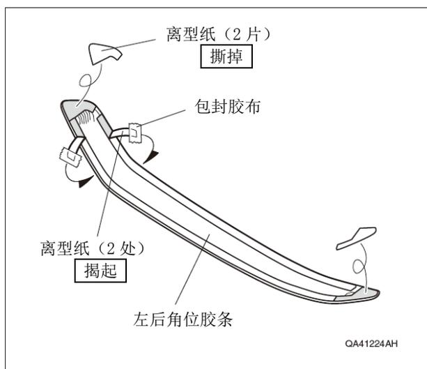
13. 确认左后角位胶条的粘贴位置，然后脱脂清洗干净。
