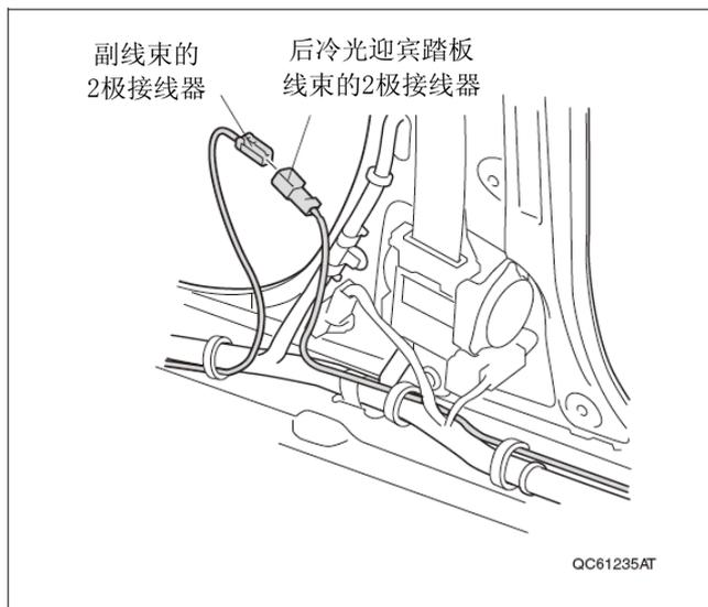
92. 用 3 条线束胶带把副线束, 2 极接线器的连接部位和后冷光迎宾踏板的线束绑在车辆线束上固定好。
