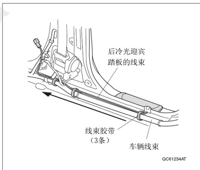
91. 把副线束的 2 极接线器连接后冷光迎宾踏板线束的 2 极接线器。
