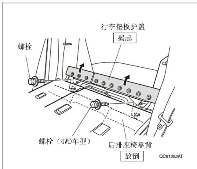
17. 拉起后排座椅靠背，拆出 2 处卡钩，拉出后排座椅坐垫。
