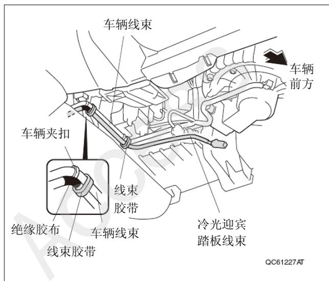
81. 用 1 条线束胶带把冷光迎宾踏板线束绑在车架上固定好。
