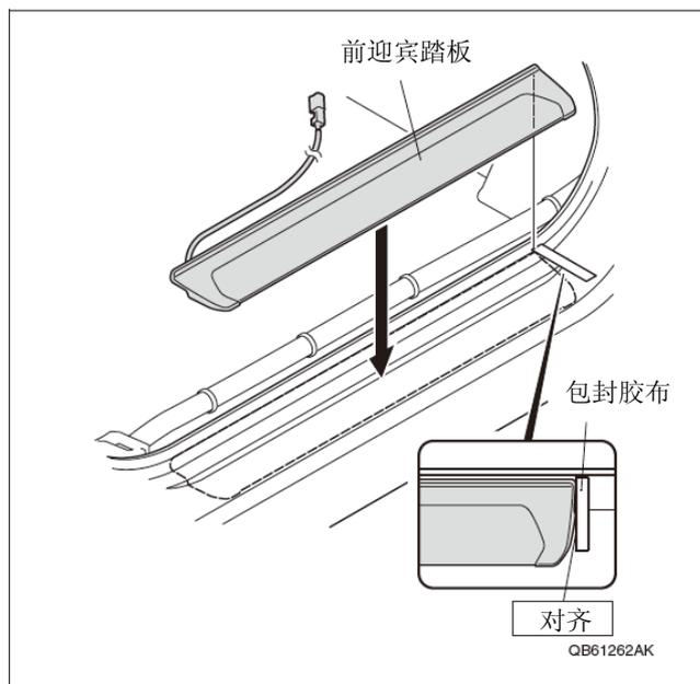
41. 确认防护胶布 A 的粘贴位置，脱脂清理干净。
