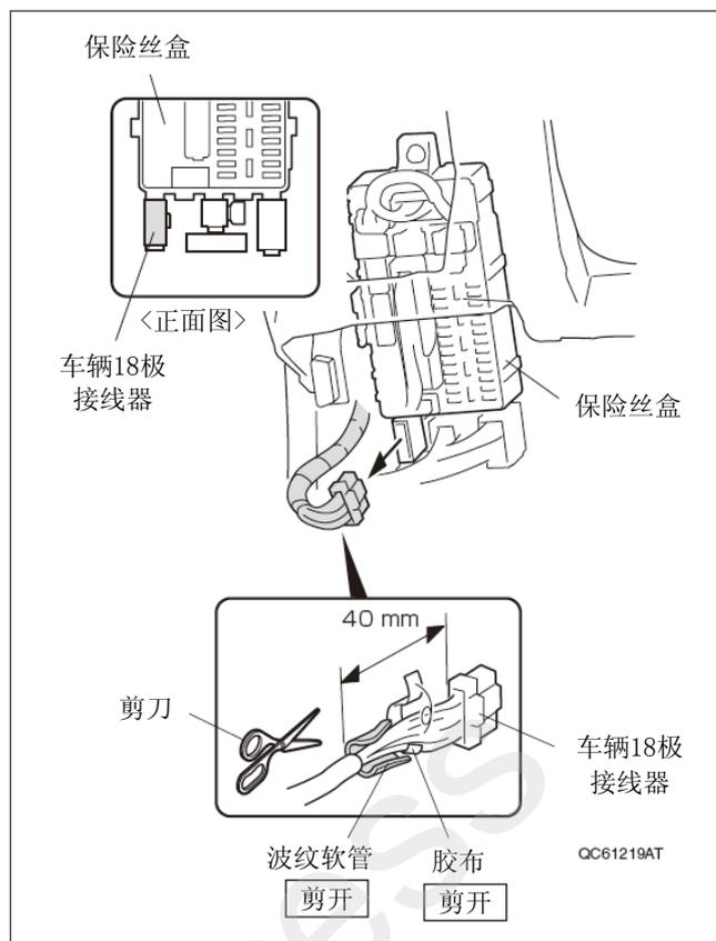
70. 用接头外罩、内盒各 2 个分别把冷光迎宾踏板线束的绿色导线连接车辆 18 极接线器的绿色导线，把冷光迎宾踏板线束的粉红色导线连接车辆 18 极接线器的粉红色导线。
