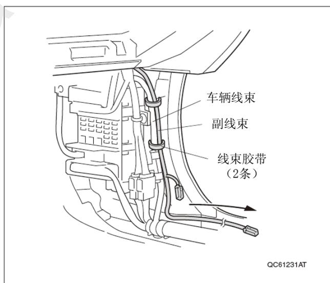
87. 把副线束的 2 极接线器连接前冷光迎宾踏板线束的 2 极接线器。
