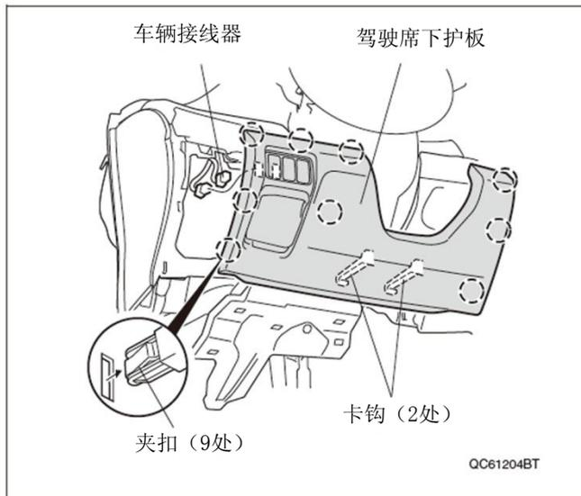
12. 拆开 2 处夹扣和 1 处止销，拆开车辆接线器的连接，然后拆出驾驶席底板。
