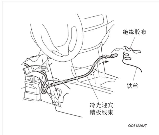
80. 把冷光迎宾踏板线束的绿色胶布对齐车辆夹扣，用 2 条线束胶带绑在车辆线束上固定好。
