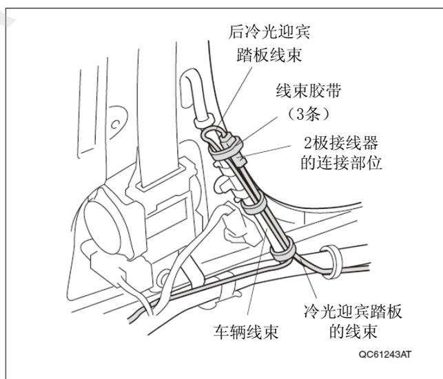
102. 把后冷光迎宾踏板线束的多余部分绑好，用3条线束胶带绑在车辆线束上固定好。
