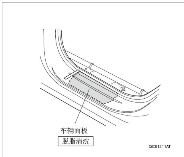
52. 揭起后迎宾踏板的 2 处离型纸，用包封胶布暂时固定在饰条表面。
