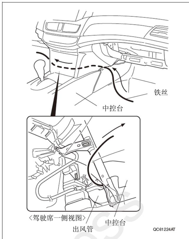
77. 用绝缘胶布把冷光迎宾踏板线束和铁丝固定在一起。
