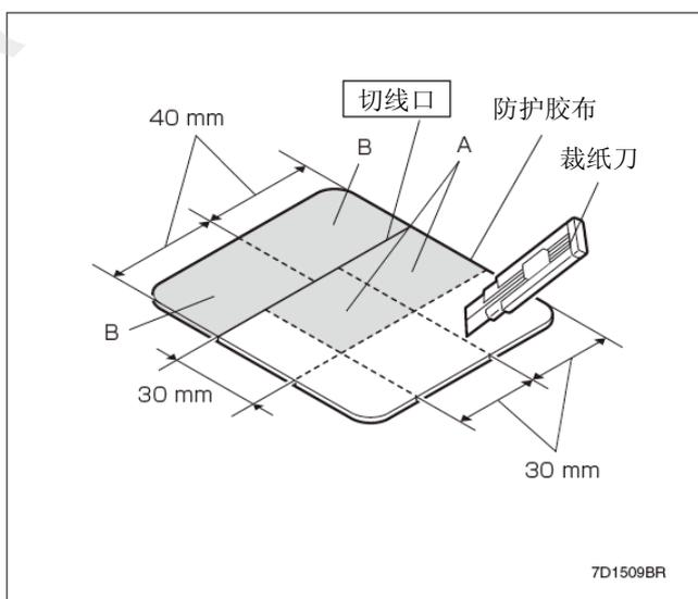
48. 确认防护胶布 A 的粘贴位置，脱脂清理干净。
