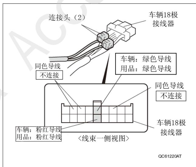
71. 用绝缘胶布把冷光迎宾踏板线束的绿色导线和粉红色导线固定在车辆线束上。
