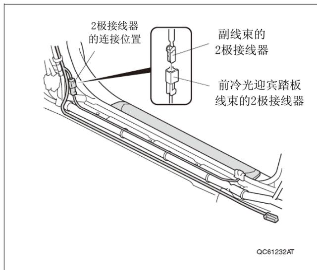
88. 用 6 条线束胶带把 2 极接线器的连接部位，副线束，前冷光迎宾踏板线束固定在车辆线束上。
