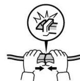
连接接头的端子时，应插入到切实锁紧为止。
