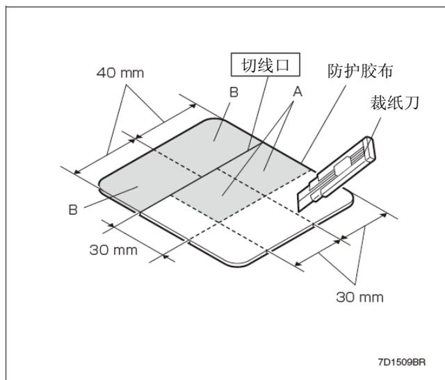
26. 确认防护胶布 A 的粘贴位置，脱脂清理干净。
