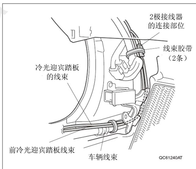
98. 把前冷光迎宾踏板线束的多余部分绑好，用3条线束胶带把前冷光迎宾踏板线束和冷光迎宾踏板线束绑在车辆线束上固定好。
