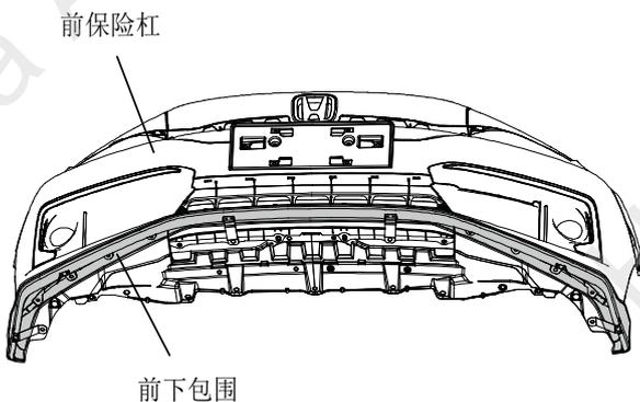
14. 临时对准前保杠和前下扰流板现有的孔位置对齐保险杠下面左右(左右各个地方)和轮毂转角的部分(左右各1个地方)的位置, 用卡扣、螺丝固定, 确定安装的位置。
