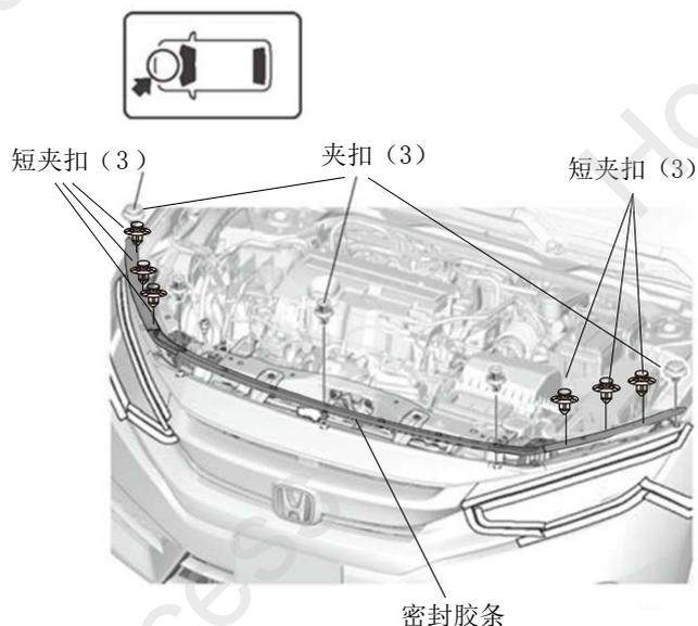
7. 拆出自攻螺丝、螺栓、内六角梅花螺栓和夹扣
